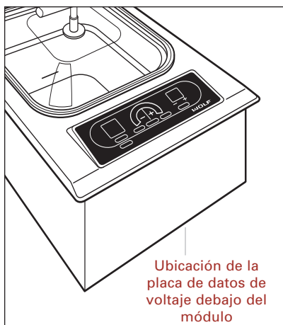
Ubicación de la placa de voltaje
